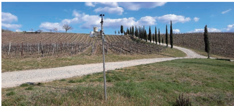
Figura 1.3: Capannina meteorologica Meteos di Pessl Instruments.
